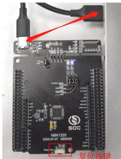
3. 打开 ISPTOOL，点击“检测串口”，然后选择相应的端口号
